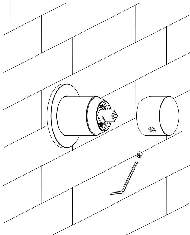
Svitare il pin della leva, svitare la brugola pre-inserita nel corpo della leva con una chiave per brugola, appoggiare la leva alla cartuccia e riavvitare.
