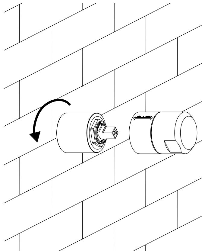
Rimuovere la protezione in plastica nera una volta completato il lavoro di rivestimento.
