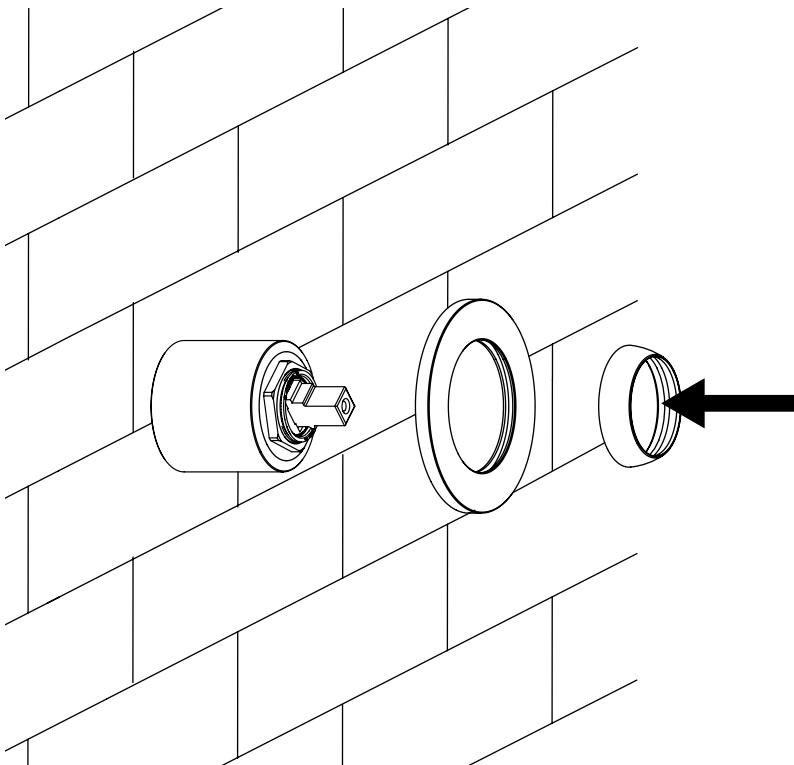
Inserire la rosetta e avvitare il copri ghiera di fissaggio al rubinetto.
