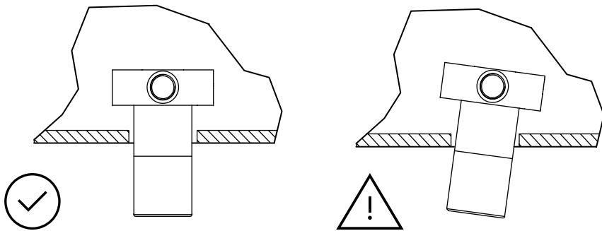
Con l'ausilio di una livella posizionare correttamente il corpo incasso sia in orizzontale che in verticale seguendo le specifiche delle figure seguenti prestando particolare attenzione alla profondità d'incasso minima e massima riportate sul cappuccio di protezione in plastica nera.
