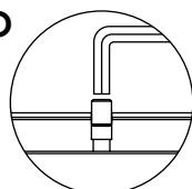
Non avvitare la vite oltre al limite, altrimenti non ruota.
